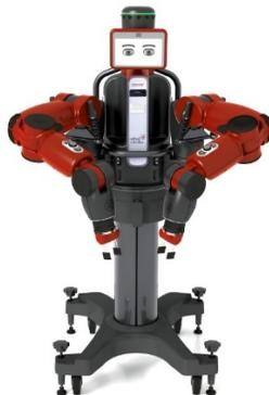
Abbildung 2: Beispiel für einen humanoid gestalteten industriellen Cobot
